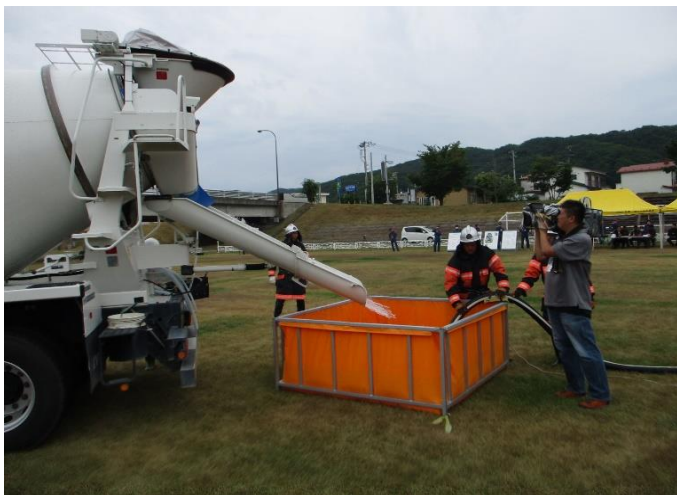
車両後方の簡易水槽へ給水①
